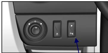
Botão de inactivação do sensor de estacionamento
